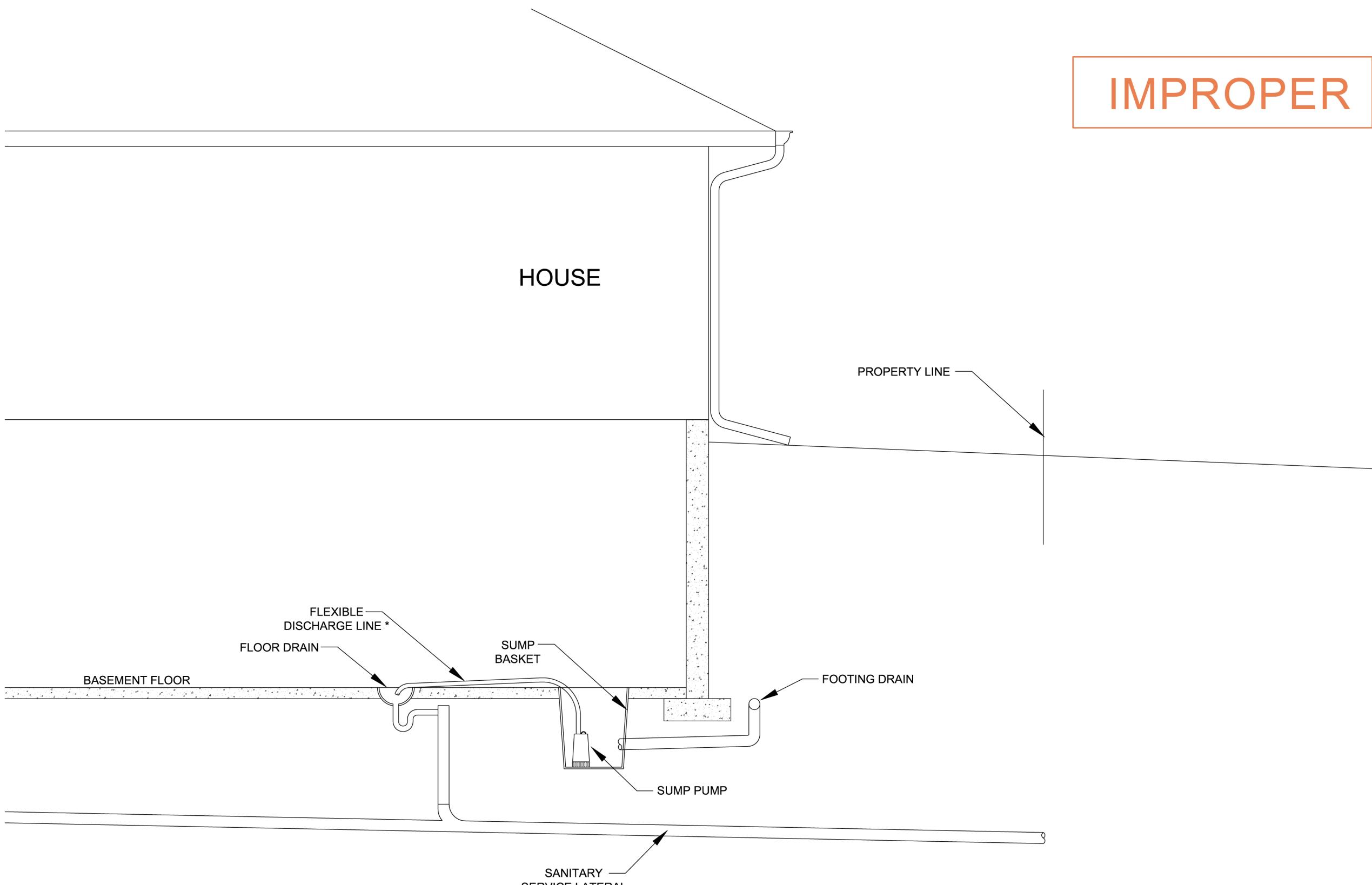
CITY OF DUBUQUE IMPROPER SUMP PUMP CONNECTION
